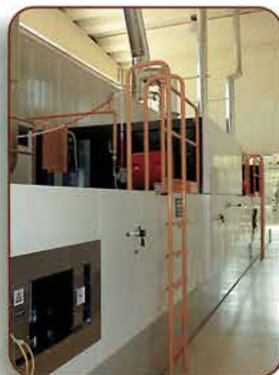
2 Scaletta di servizio e leva valvola vapori. Back stairs, steams exhaust valve.
